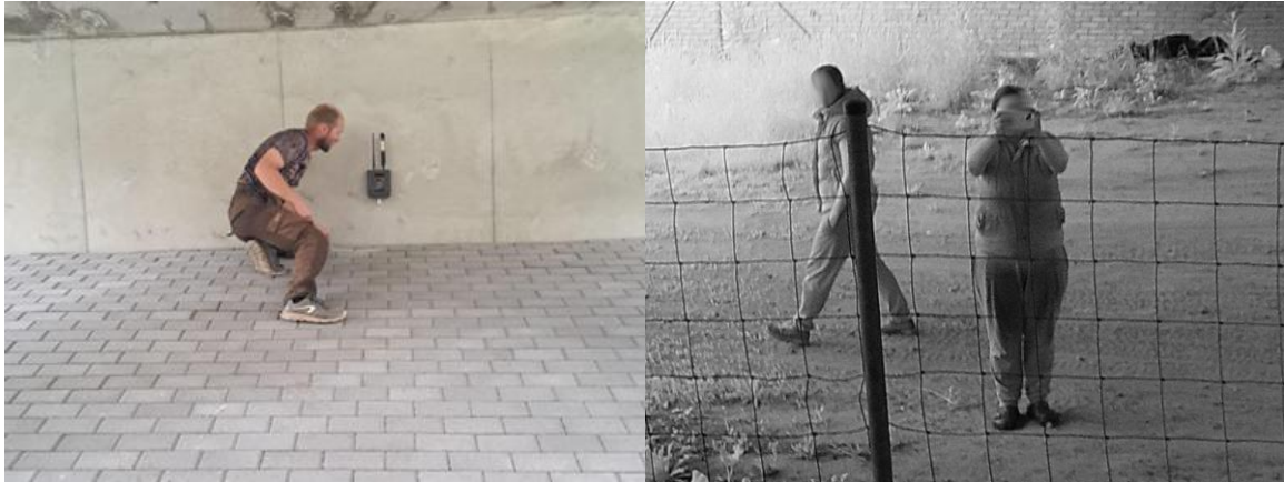
FOTOD 3 JA 4. Tammemäe suurulukitunnelis paigaldati rajakaamerad turvapuuridesse (vasakul), et vähendada vargustest ja vandalismist põhjustatud andmekao ohtu. Kaamerad ei jäänud tunneli kasutajatele märkamata ning möödujad ka pildistasid neid (paremal). Siiski töötasid rajakaamerad katkestusteta seireperioodi lõpuni.
