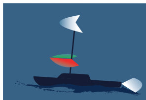
Laeval pikkusega vähem kui 20 m võivad pardatuled olla kõrvuti ühes laternas
